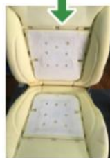
开浅坑加高弹耐疲劳3D棉蓄风槽 基本不改变发泡海绵结构 无塌陷风险 用3D导风层和皮一体化缝制 提升皮的饱满度和透气性 也可以直接沿用原车皮和海绵 原有加热垫上通几个小孔即可 不破坏加热垫强度,也省时
