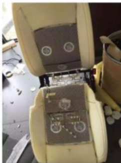
轴流式风扇埋入式,风机内置 安装相对方便些 但某些座椅的风机布置 位置比较困难
