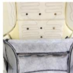
打小孔 基本不改变发泡海绵结构 无塌陷风险 用3D导风层和皮一体化缝制 提升皮的饱满度和透气性 也可以直接沿用原车皮和海绵 原有加热垫上通几个小孔即可 不破坏加热垫强度, 也省时
